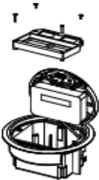
Ослабьте винты с помощью крестообразной отвертки и отсоедините обжимную пластину. Снимите резиновый колпачок с кабельных вводов выходного отверстия, которое необходимо. Прикрепите обжимную пластину к нижней части коробки, затянув винты.
