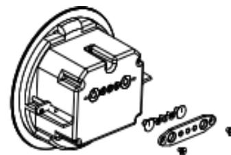
Пропустите провода через отверстие в полу. Затем пропустите их через обжимную пластину и резиновые кабельные вводы в коробку. Убедитесь, что провода выступают из напольной коробки на 60 мм.
