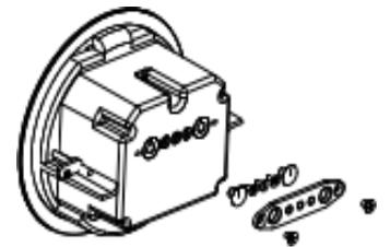
Пропустите провода через отверстие в полу. Затем пропустите их через обжимную пластину и резиновые кабельные вводы в коробку. Убедитесь, что провода выступают из напольной коробки на 60 мм.
